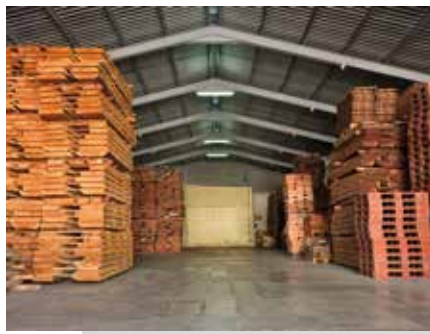
Immagazzinaggio da 2 a 4 anni per dare al legno il massimo della stabilità prima del processo costruttivo
