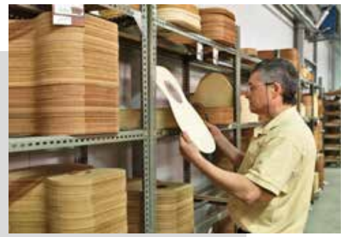
Immagazzinaggio da 2 a 4 anni per dare al legno il massimo della stabilità prima del processo costruttivo
