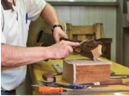
Proceso: acuchillado y lijado
