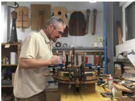
Proceso: montaje y fijación de viretes
