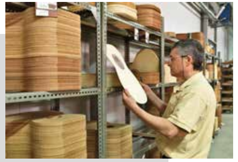
Almacenamiento de 2 a 4 años de las maderas para lograr su máxima estabilización antes de proceso
