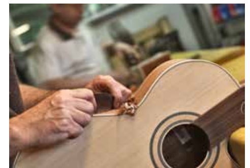
Prozess: Schleifen der Zargen
