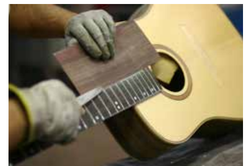
Prozess: Einsetzen der Bundstäbe
