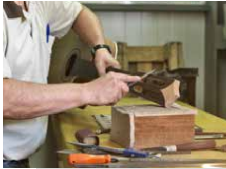
Prozess: Hobeln und Schleifen
