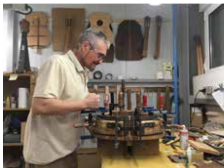
Processus: montage et fixation des barrages
