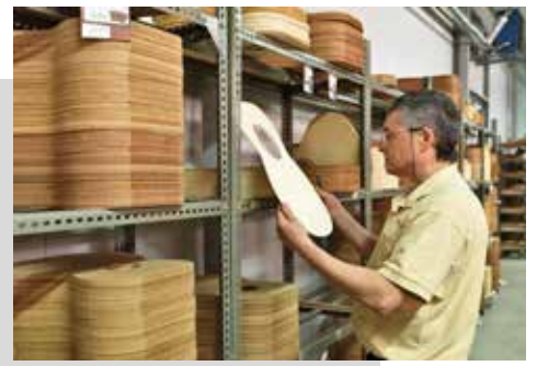
Stockage de 2 à 4 ans du bois pour un séchage et une stabilisation maximale avant les processus de fabrication.
