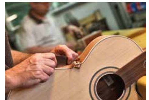
Processus: ponçage des éclisses
