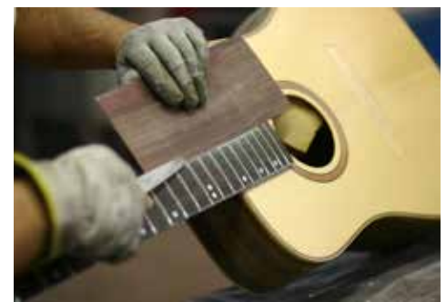
Processus: pose des frettes
