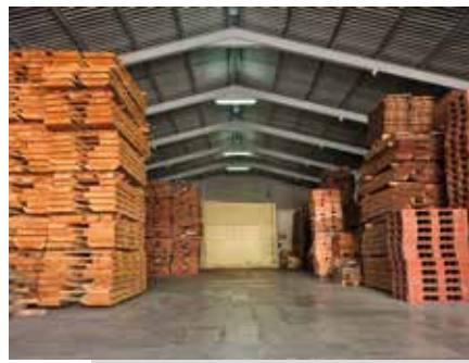
Stockage de 2 à 4 ans du bois pour un séchage et une stabilisation maximale avant les processus de fabrication.
