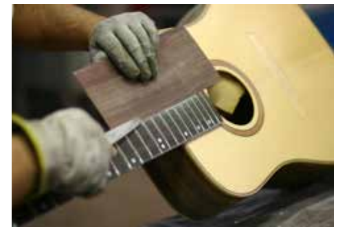
工程作業:フレットの取り付け
