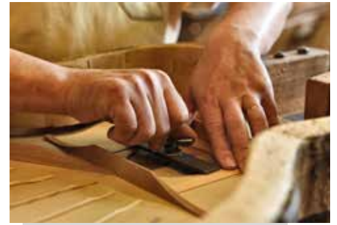
工程作業:ブレイシングの調整
