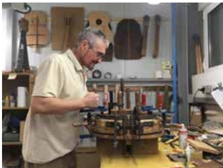
工程作業:バインディングの接着と組み立て
